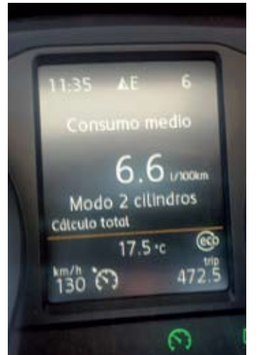
▲ Cuando la carga del motor lo permite, el sistema ACT desconecta los dos cilindros centrales.
