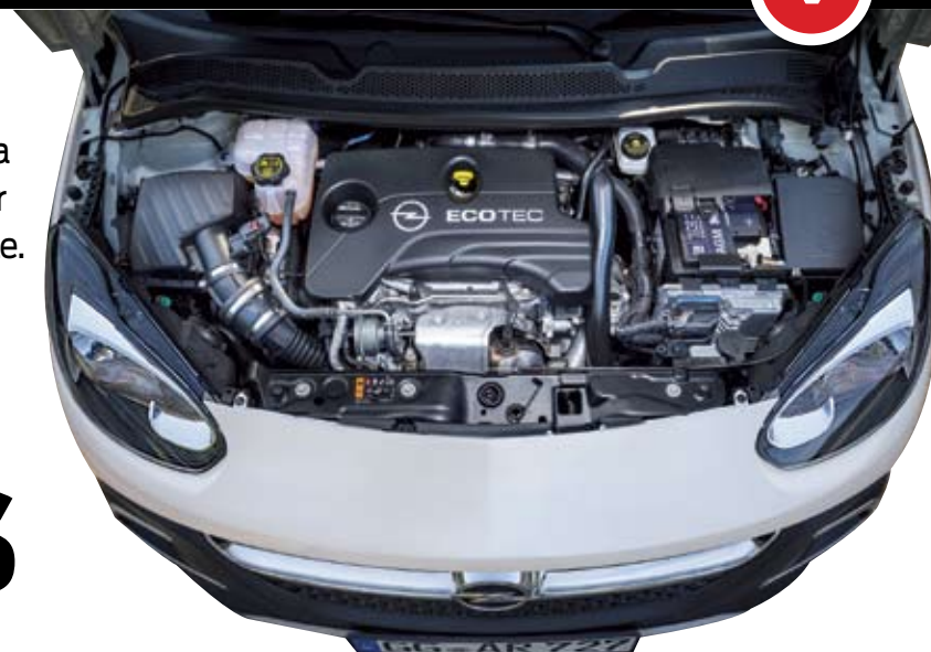
▲ En el ADAM, el motor 1.0 ECOTEC Turbo de inyección directa con 115 CV permite acelerar hasta 100 km/h en 9,9 segundos o alcanzar 196 km/h.
