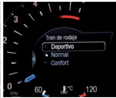
▲▲ La suspensión adaptativa CCD es opcional con tres niveles de dureza: Deportivo, Normal y Confort. Pero falta un interruptor más accesible.
