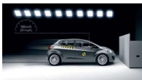
IMPACTO FRONTAL COMPLETO.- A 50 kilómetros por hora el vehículo choca de frente contra una barrera rígida, con un 'dummy' de mujer en el asiento del conductor y otro en la plaza trasera del lado del copiloto. Se introduce en 2015.
