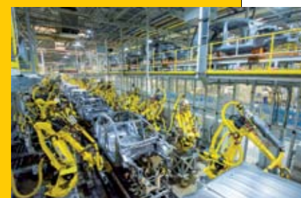
▲ Todo un ejército de robots ensambla el Kia Cee'd en la fábrica eslovaca de Zilina.
