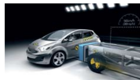
IMPACTO LATERAL.- Una barrera deformable se impulsa a 50 km/h contra la unidad de la prueba detenida en ángulo recto. El conductor es un dummy varón de talla media y detrás van los que representan niños en sillas de retención infantil. Se introduce en 1997 y actualiza en 2015.
