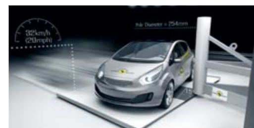
IMPACTO LATERAL DE POSTE.- A 32 km/h un vehículo se lanza lateralmente y en un pequeño ángulo alejado de la perpendicular (desde este año) hacia un mástil rígido y estrecho. El conductor es un 'dummy' masculino de talla media. Se introduce en 2001 y actualiza en 2015.
