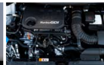
◀ Nuevo motor 3 cilindros gasolina T-GDi, que destaca por su buena respuesta al acelerador.
