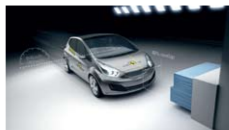
IMPACTO FRONTAL SOLAPADO.- A 64 km/h el vehículo impacta con un 40 por ciento del frontal contra una barrera deformable, que representa un vehículo que se aproxima. Supone una colisión entre dos coches del mismo peso a 50 km/h. Van dos 'dummies' varón de talla media delante y 'niños' en sistemas de retención detrás. Se introduce en 1997 y actualiza en 2015.
