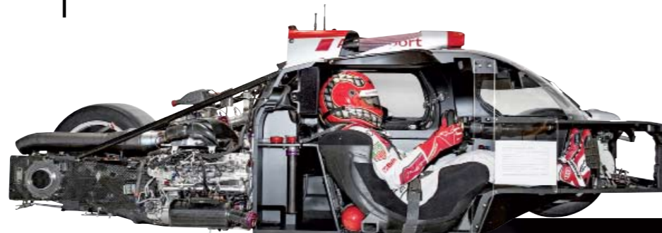
Le Mans es un banco de ensayos de primer nivel. Los faros láser fueron probados en los Audi R18 y los utiliza el Audi R8 LMX. De aquí también han salido los frenos cerámicos, que ahorran hasta 6,5 kilogramos cada uno.
