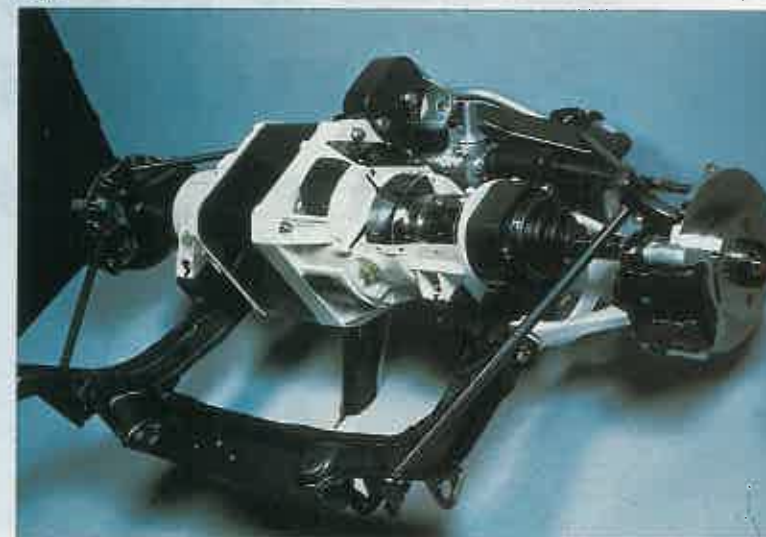
El motor eléctrico del futuro Clio es de muy reducidas dimensiones y se acopla sobre el eje delantero.
