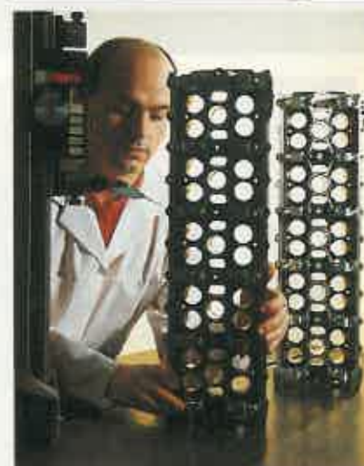
Al llegar a Renault Sport, las culatas mecanizadas por Mecachrome pasan un severo control dimensional.
