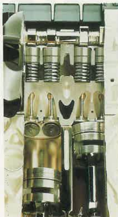
La culata de cuatro válvulas por cilindro permite que el motor respire mejor y que su rendimiento energético sea superior. Con 1.700 c.c. logra 140 caballos.
