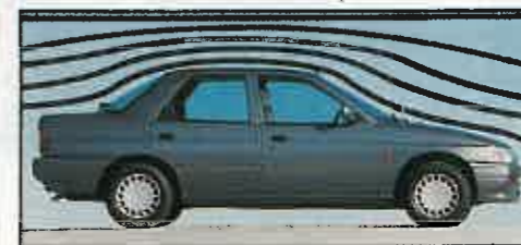
COEFICIENTE AERODINAMICO DE 0,33.
