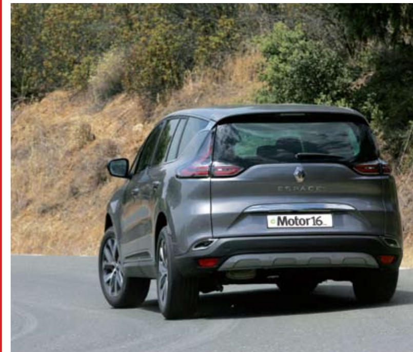
▲ Con el sistema 4Control que incluye dirección a las 4 ruedas y suspensión regulable, el Espace se mueve con mucha soltura en carreteras viradas.
