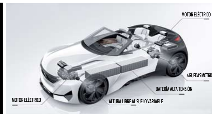
▲ Además de ser eléctrico, tracción total y tener 204 caballos, el Fractal cuenta con un sistema de audio 9.1, primicia mundial.
