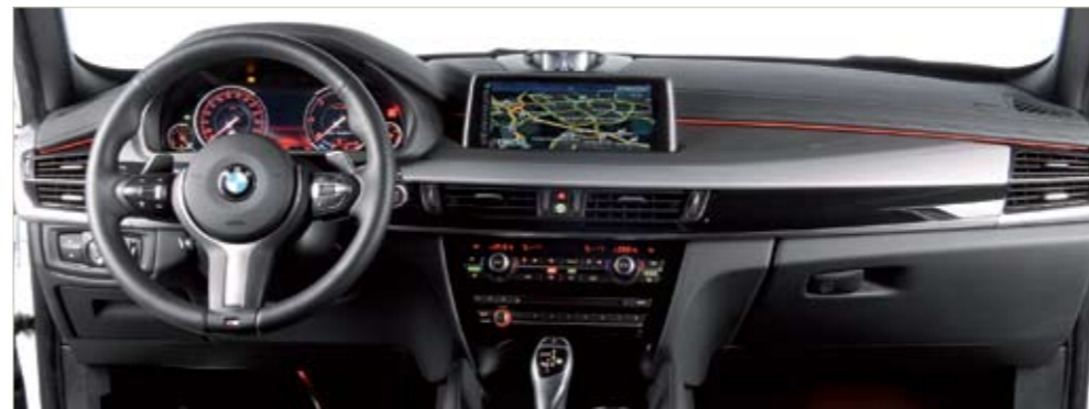
▲ El cambio Steptronic de 8 marchas tiene función 'Launch Control' y 'navegación a vela', que se activa en modo EcoPro, y entre 50 y 160 km/h. Es un 14% más eficiente que su antecesor.
