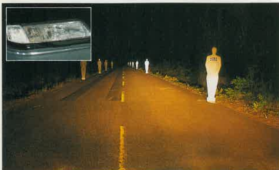
SUPERFICIE COMPLEJA. Haz ancho e iluminación intensa y penetrante.
