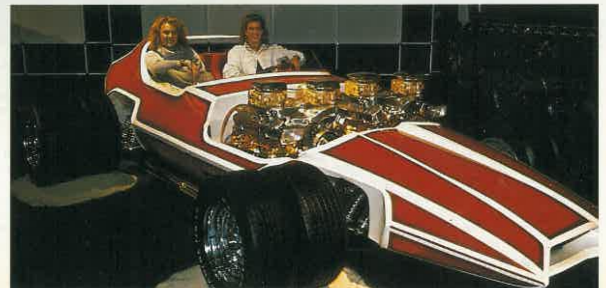
MAS DE MIL CABALLOS El «Invader», una especie de Fórmula 1 con ocho ruedas, dos motores de 8 cilindros en V y una potencia superior a los mil caballos.
