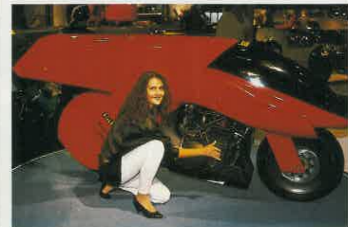
RECORD DE VELOCIDAD Fruto de la colaboración entre I. Design y Fritz Egli, es esta motocicleta con la que se quiere batir el récord del mundo de velocidad. La Egli Red Shark utiliza un motor de 4 cilindros Kawasaki de 300 caballos y supera los 450 kilómetros por hora.
