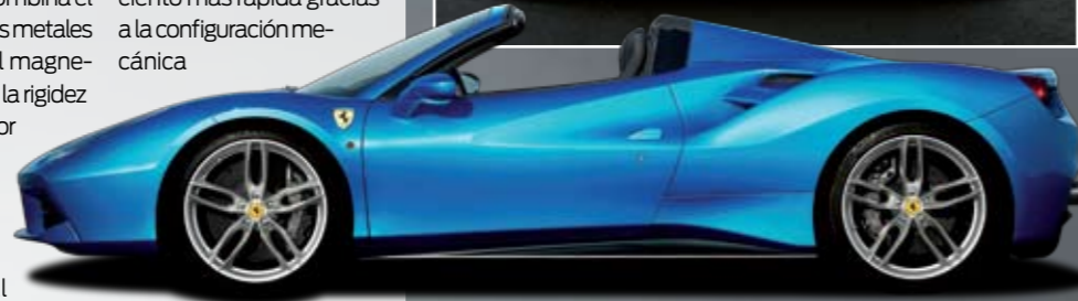
▲▼ El techo duro retráctil del 488 Spider permite capotar o descapotar el coche en 14 segundos. Ahorra 25 kilos respecto a uno de lona, y sus dos secciones se recogen superpuestas sobre el motor central. La luneta eléctrica paravientos puede ajustarse en tres posiciones.
