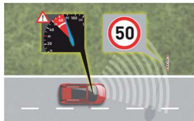
▲ El Limitador Inteligente de Velocidad evitará multas al ajustar la velocidad automáticamente al límite establecido en cada momento.
