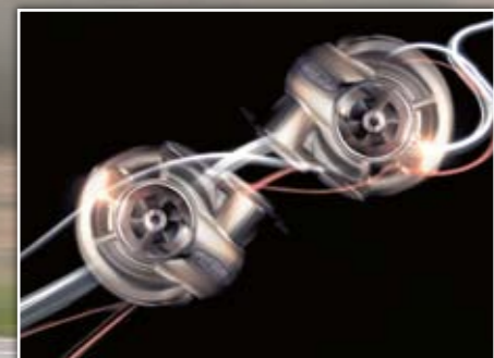
◀◀ La versión 2.0 TDCI de 210 caballos apuesta por dos turbos para una mayor eficacia. Debajo, detalle del sofisticado cuadro de mandos configurable.
