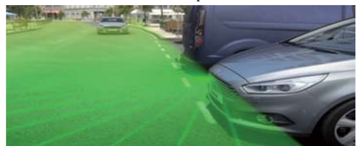
◀▶ La Alerta de Tráfico Cruzado avisa al conductor de la presencia de un vehículo cuando salimos marcha atrás de una plaza de aparcamiento. Añade, además, una cámara frontal con visión partida.
