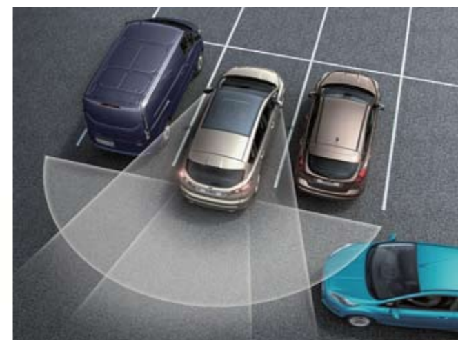
◀▶ La Alerta de Tráfico Cruzado avisa al conductor de la presencia de un vehículo cuando salimos marcha atrás de una plaza de aparcamiento. Añade, además, una cámara frontal con visión partida.
