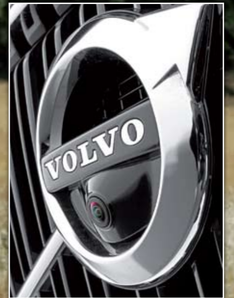
▲ La cámara frontal escondida en el escudo forma parte del sistema de visión periférica 360°. La imagen que llega al conductor es impresionante.
