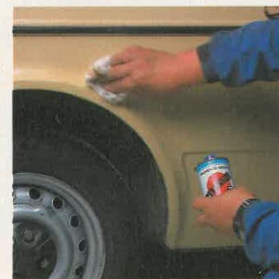
Para el acabado final, frote con otro algodón empapado en abrillantador sobre la parte reparada y sus alrededores o incluso sobre todo el coche, para evitar que se forme una aureola alrededor de la reparación.
