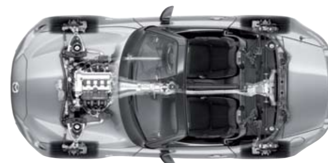
▲ Prima la dinámica. Por ello se retrasa el propulsor, hay suspensiones independientes, carcasa del diferencial de aluminio...
