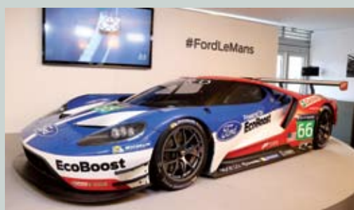
◀ Ford volverá a las 24 Horas de Le Mans en 2016 en la categoría GTE Pro con este Ford GT dotado de un motor V6 Ecoboost twin-turbo de 3,5 litros de cilindrada. El chasis de este imponente coche de competición será de fibra de carbono.
