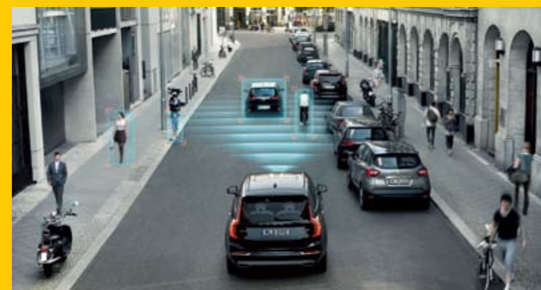
▲ Los sistemas de frenado automático reducen un 28% las colisiones traseras.
