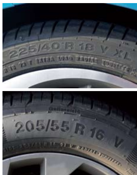
La diferencia de consumos entre TSI y TDI ha sido mínima, y eso que la unidad probado con el motor de gasolina era acabado FR e iba provista de unos neumáticos 225/40 R18 de mayor medida que los 205/55 R16 del TDI y por consiguiente algo más 'gastones'.
