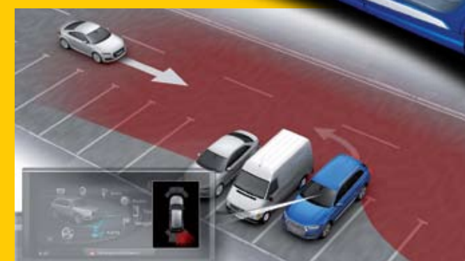
▲ El Cross Traffic Assist –paquete City– ayuda a salir marcha atrás de zonas sin visibilidad. Avisa de riesgos por ambos lados, e incluso frena.
