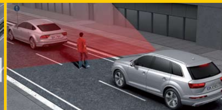
▲ El Pre Sense City controla el entorno hasta 100 metros de distancia para detectar vehículos y peatones. Actúa hasta 85 km/h, y hasta 40 km/h puede evitar la colisión.
