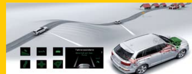
▲ El Asistente de Eficiencia Predictiva –paquete Tour– ajusta la velocidad preseleccionada a las condiciones: topografía, límites de la vía, tráfico...
