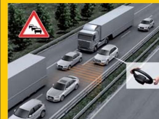
▲ El Asistente en Atascos –paquete Tour– llega a hacerse cargo de la dirección, y opera entre 0 y 65 km/h.
