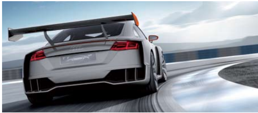
◀ El TT Clubsport Turbo Concept, inspirado en el Audi 90 IMSA GTO de la década de 1980, tiene una carrocería ensanchada 14 centímetros, discos de freno cerámicos y un motor de 600 CV con doble turbo eléctrico. Su alerón trasero es ajustable.
