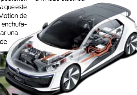
▲ Bajo el capó delantero va el motor de gasolina y uno de los eléctricos. El segundo va detrás, junto a la batería.
