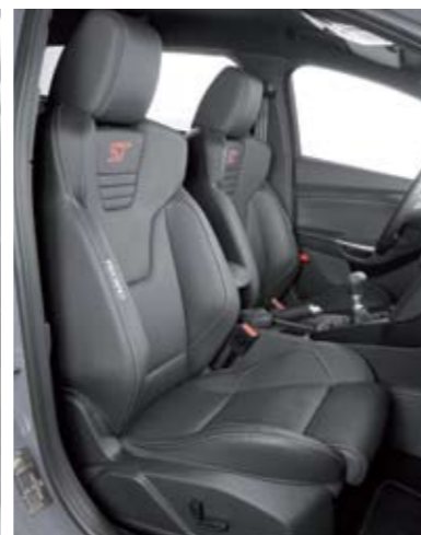
▲ Asientos Recaro tapizados en cuero. Los delanteros son eléctricos y tienen climatización. Su respaldo, con pétalos muy marcados, es demasiado estrecho, mientras que detrás no puede equipar reposacabezas para la plaza central.
