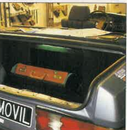
CAJAS FUERTES Esta caja fuerte se encuentra anclada al chasis del vehículo
