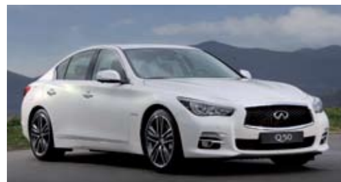
▲ El Q50 es el más largo y el de mayor maletero. Tiene un Cx de 0,26 y mecánica Mercedes, pero no es ligero.
