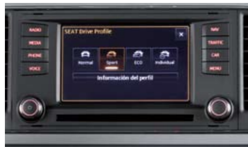
◀ Con el Seat Drive Profile, de serie en los X-Perience DSG, podemos elegir el modo de conducción, que ajusta dirección, respuesta del motor y leyes de cambio. Y pronto podrá pedirse amortiguación DCC.
