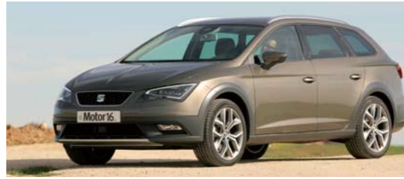
▶▶ Los 27 milímetros extra de altura al suelo se agradecen al circular fuera de carretera o sobre nieve, pero hay que tener claro que no es un todoterreno. Los neumáticos opcionales, unos 225/45 R18, tienen muy poco perfil.
