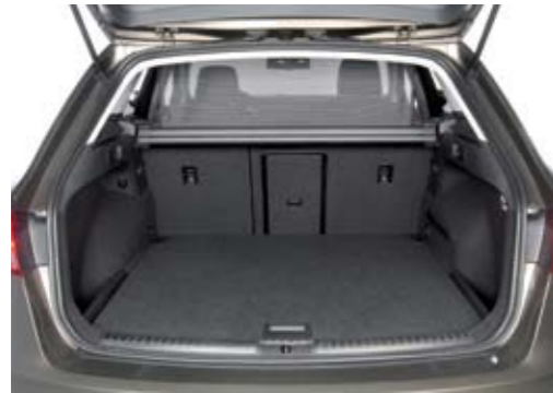
▲▼ El maletero mantiene el volumen de otros León ST pese al sistema de tracción total: 587 litros. Bajo el suelo va una rueda de repuesto, aunque de emergencia.
