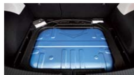
▲ Para ubicar los depósitos de gas se utiliza el hueco de debajo del maletero.
