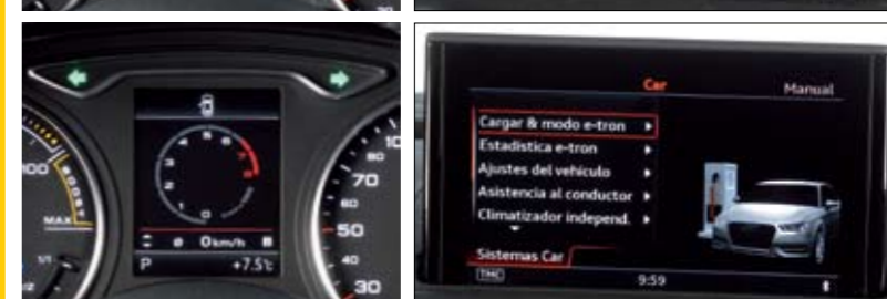
▲▲ El display de la instrumentación ofrece las funciones típicas de otros A3 y las específicas del e-tron, incluido el cuentavuelvas del motor TFSI.
