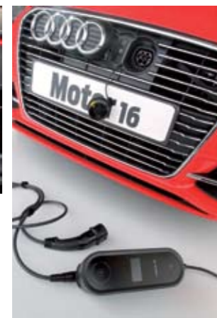
▶▶ El motor TFSI ha sido desplazado 6 centímetros para dejar hueco al eléctrico. En la toma de carga, tras el logo del frontal, se enchufa el cable, algo aparatoso.
