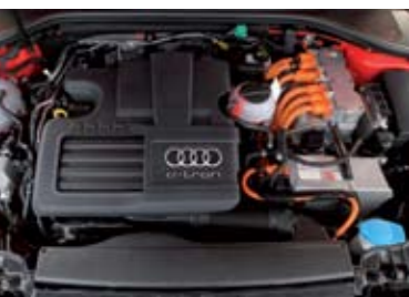
▶▶ El motor TFSI ha sido desplazado 6 centímetros para dejar hueco al eléctrico. En la toma de carga, tras el logo del frontal, se enchufa el cable, algo aparatoso.
