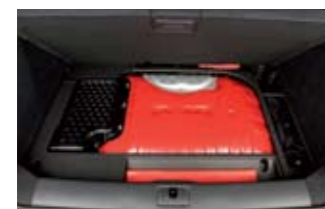
▲ La ubicación de la batería de iones de litio bajo el maletero deja el volumen de carga en 280 litros; pero se puede ampliar a 1.120 litros.
