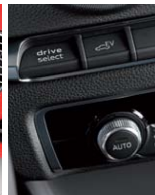
▶▶ En la consola, sobre los mandos de climatización, va el habitual botón del Drive Select, que permite elegir el modo de conducción, y el botón EV, para configurar el flujo eléctrico.
