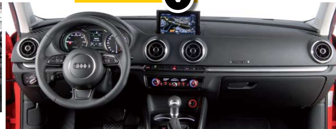
▶▶ La pantalla principal recoge los menús de funcionamiento, y permite ver modos de conducción, proceso de recarga de la batería, estadísticas...
