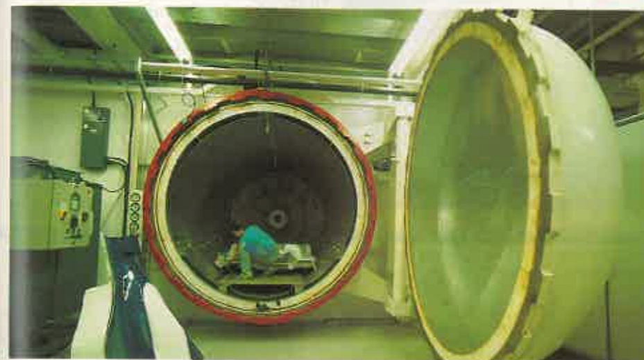
HORNO TECNOLÓGICO. En este autoclave se cuecen todos los chasis y demás componentes de fibra de carbono.
