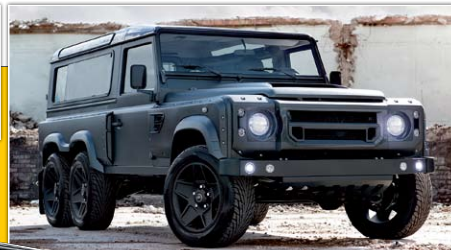
▶▶ El Defender Huntsman concept es un imponente vehículo con tracción 6x6 y un poderoso motor V8 de 430 caballos que le convierten en un vehículo imparables en todos los terrenos.
