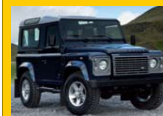
▲ Desde 1983 se llama Defender. Ya monta frenos de disco y sustituye las ballestas de suspensión por muelles.
