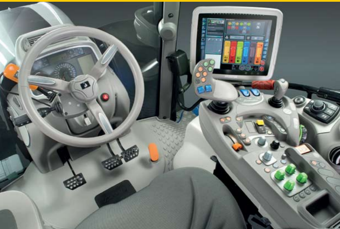
▲▼ La cabina es como un avión. Los mandos están agrupados por funciones e identificados por colores. El joystick es un mando clave y debajo el ASM activa o desactiva la tracción integral o los diferenciales según velocidad y giro de las ruedas.
