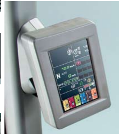
▲▲ Los mandos de las luces se agrupan en un solo mando. El interior del tractor está repleto de huecos portaobjetos. Una pantalla a color muestra toda la información.
