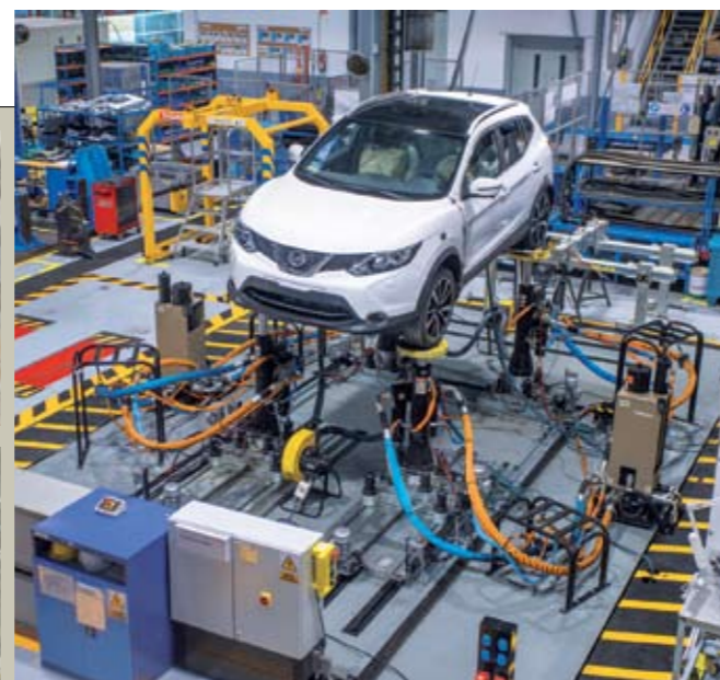
► Sobre cuatro plataformas hidráulicas, que se van moviendo simulando la carretera, los modelos de Nissan son probados en sesiones que pueden ser de 24 horas sin interrupción.
