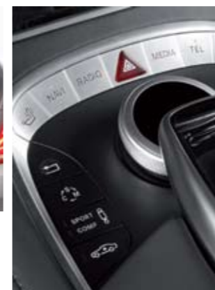
▶ La suspensión neumática se puede regular en altura y en dureza con posiciones Sport y Comfort. El cambio tiene tres modos.
