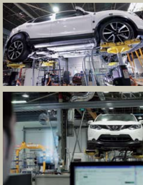
► Sobre cuatro plataformas hidráulicas, que se van moviendo simulando la carretera, los modelos de Nissan son probados en sesiones que pueden ser de 24 horas sin interrupción.
