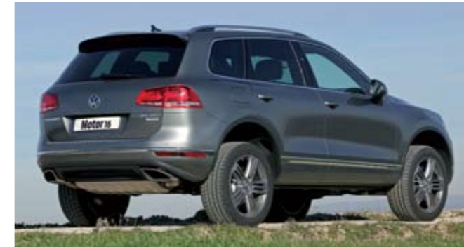
▲ Con la suspensión neumática –3.660 euros– podemos llevar la altura al suelo hasta 30 centímetros. A más de 140 km/h recupera la cota normal.
