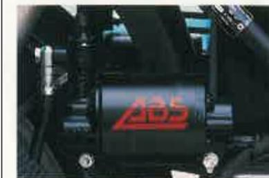
cer. Una excepcional eficacia en la frenada, garantizada por sus nuevos frenos de 305 mm. de diámetro, y una horquilla aún más resistente, junto a la opción del ABS, sistema exclusivo de BMW.
