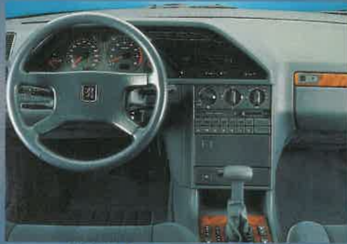
CAMBIO AUTOMÁTICO. Además del motor diesel de tres válvulas por cilindro (a la derecha), la gran novedad de Peugeot en el 605 es el cambio automático de cuatro marchas
