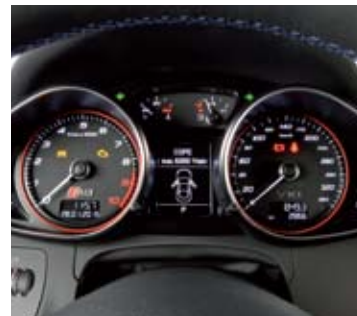
◀▲ Los bacquets, excelentes por confort y sujeción, carecen de airbag laterales. Tras ellos cabe equipaje 'de mano' si no los llevamos muy retrasados. La zona roja del cuentavueeltas va de 8.500 a 10.000 rpm, y los 570 CV llegan a 8.000 rpm.
