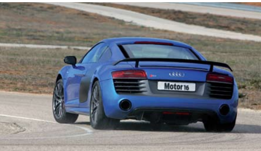
▲ Los neumáticos traseros son más anchos que en otros R8 V10... y no vienen mal. Los discos cerámicos, aquí de serie, se traducen en unas frenadas espectaculares.
