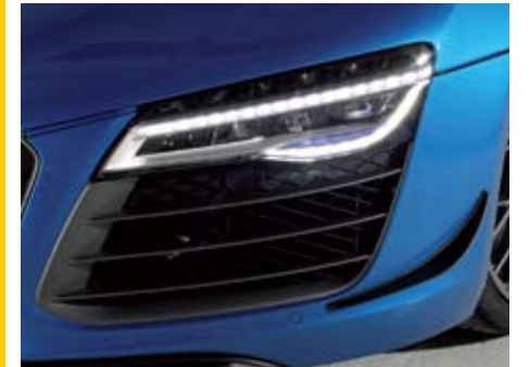
▲▲ El R8 LMX aplica la tecnología de faros láser a las luces de carretera. El alcance es impresionante, y en una autopista recta se ve a enorme distancia, pero en carretera normal las ventajas son menores. De hecho, los cambiaríamos por faros orientables.
