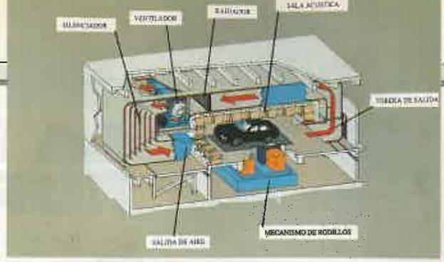
de los problemas más graves en este tipo de instalaciones. La temperatura de la vena de aire se puede regular entre 10 y 50 grados centígrados. Los primeros experimentos del túnel se han hecho con el Audi V-8 de cambio manual.
