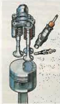
**MULTIVALVULAS.** El motor diesel es el de tres válvulas por cilindro, igual al del XM.
