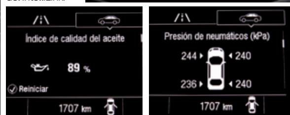
► Entre los datos del display de 3,5" de la instrumentación figura la presión de neumáticos o la calidad del lubricante. A la derecha, la pantalla de 7" del IntelliLink.
