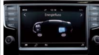
▲ La pantalla táctil muestra autonomía, nivel de carga de la batería, flujos de energía y otras funciones habituales.
