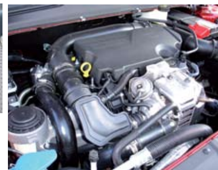
El pequeño motor de 3 cilindros ▲ desarrolla 125 CV de potencia en el Mondeo.
