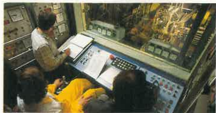
BANCOS DE PRUEBA. De las cinco cabinas, cuatro son para el estudio informatizado de los motores. En la otra hay un propulsor conectado a un cambio con diferencial.
