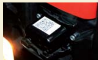
▲ Un cajetín telemático en la toma de diagnóstico del vehículo recoge y transmite los datos.
