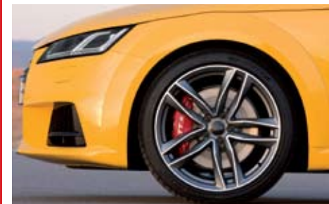
▲ El TTS monta discos ventilados en ambos ejes y neumáticos de mayor medida de serie: unos 245/40 R18.
