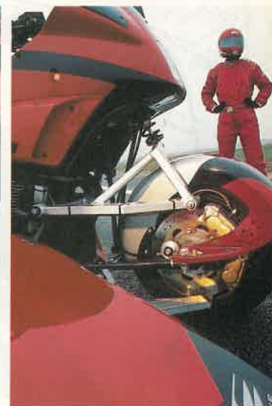
UNA SOLUCION PRACTICA. Jean Claude Perrin ha optado por hacer una suspensión sencilla y nada complicada si se quiere separar el sidecar de la moto.
