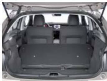
▲ Maletero de 300 litros, excelente para un utilitario de 3,94 metros de largo. El respaldo se abate por partes, pero el borde de carga va algo alto.
