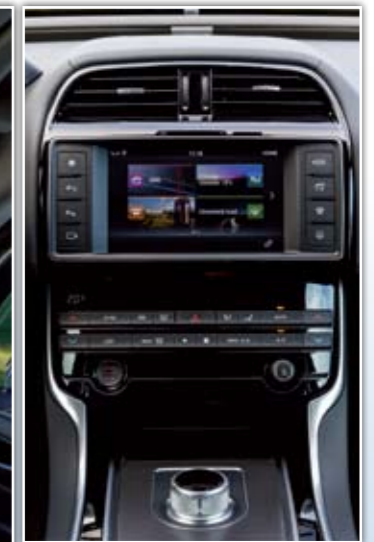
▲ Los automáticos tienen el selector circular que emerge al arrancar. Hay arranque por botón, freno de estacionamiento eléctrico...
