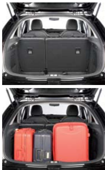
▲ Maletero de 300 litros, excelente para un utilitario de 3,94 metros de largo. El respaldo se abate por partes, pero el borde de carga va algo alto.
