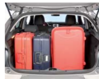
▲ Uno de los sitios donde se notan los 21,6 centímetros extra de longitud del C4 Cactus es el maletero, de 358 litros. Pero el borde de carga también queda alto y, peor aún, el respaldo sólo se puede abatir como una pieza.
