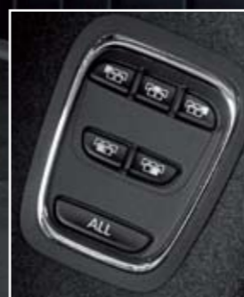
La tercera fila de asientos va asociada al sistema One Touch que permite abatir los respaldos de los cinco asientos de la 2ª y 3ª fila de forma automática incluso desde la pantalla R-Link2
