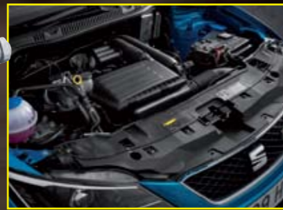
◀ El sistema ACT desconecta los cilindros innecesarios del motor cuando se acelera suavemente o si el cambio está en punto muerto. Ahorra mucha gasolina.
