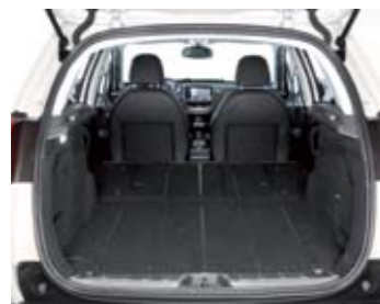
▲▲ Aunque el 208 mide sólo 3,96 metros de longitud, su maletero es muy capaz: 285 litros, ampliables a 1.076 si abatimos el respaldo trasero.
