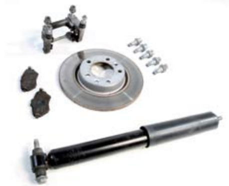
▲ Los amortiguadores traseros del 308 de la prueba han acabado el kilometraje exigido con una eficacia del 90 por ciento.
