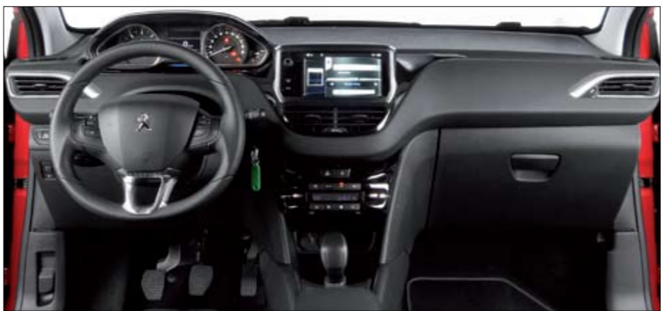
► El 208 fue el primer modelo de la marca gala dotado del llamado 'i-Cockpit', un puesto de conducción innovador por el pequeño tamaño del volante, la elevada posición de la instrumentación y la proximidad de la pantalla táctil.
