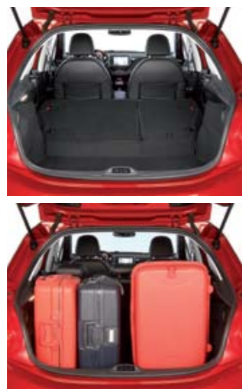
▲▲ Aunque el 208 mide sólo 3,96 metros de longitud, su maletero es muy capaz: 285 litros, ampliables a 1.076 si abatimos el respaldo trasero.
