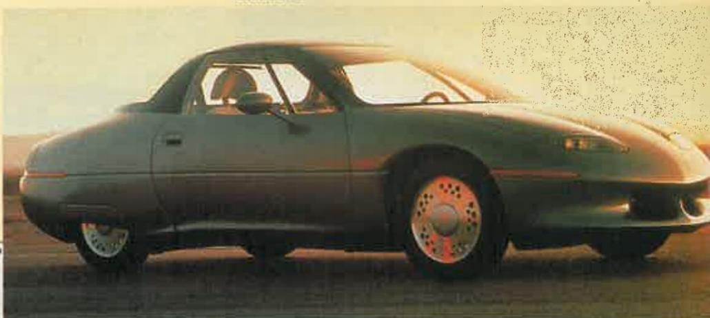
cada uno, acoplados uno en cada rueda delantera, con una velocidad de giro de 6.600 revoluciones por minuto. Utiliza para el almacenamiento de energía, 32 baterías de 10 voltios, ubicadas en el túnel central, con un peso de 870 libras (alrededor de 400 kilos). Esto le proporciona una autonomía de 200 kilómetros a 90 kilómetros por hora, con un tiempo de recarga de 6 a 8 horas.
