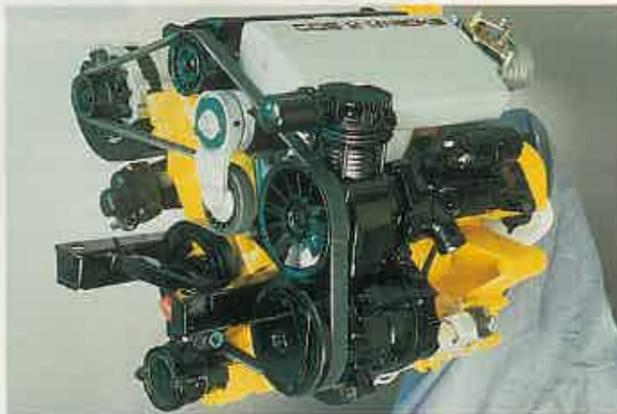
El motor de dos tiempos de General Motors, tiene 1.500 centímetros cúbicos y desarrolla 110 caballos gracias a un sistema de inyección directa. Pesa casi la mitad que un motor equivalente de cuatro tiempos.
