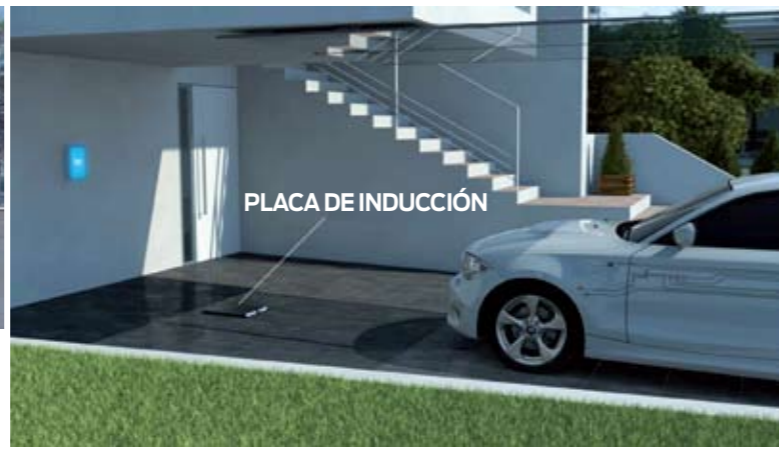
▲ Con la recarga sin cable de las baterías de alto voltaje, BMW quiere simplificar el uso de sus vehículos eléctricos o con mecánica 'plug-in hybrid'. El sistema se basa en una placa de inducción, situada en el suelo del garaje, que recargaría la batería del i8 en dos horas.
