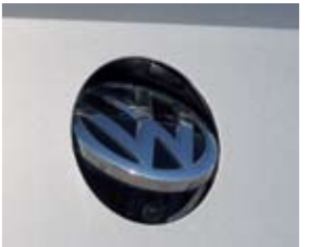
▲▲ La cámara de marcha atrás se esconde bajo el logo trasero. El portón puede ser eléctrico por 480 euros. La cerradura del portón abierto queda a 1,90 metros del suelo.
