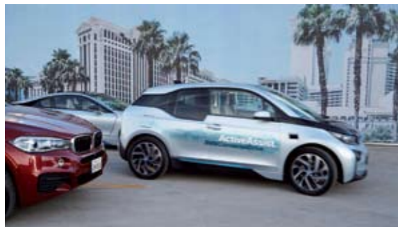
▲ Con el Remote Valet Parking Assistant, el i3 puede aparcar automáticamente, sin conductor, comparando un plano digital del área con los datos captados por cuatro escáneres. Cuando queramos irnos podremos llamarle desde un reloj 'smartwatch'.
