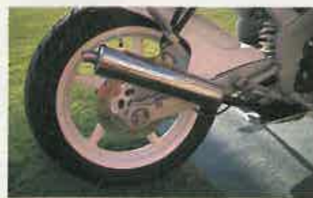
El chasis de la SP 01 es del tipo Deltabox y su freno de 220 milímetros tiene tacto progresivo.
