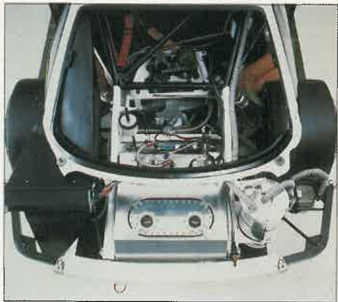
El motor, un cinco cilindros en línea va colgado por delante del eje anterior. Los técnicos de Audi han situado el depósito de gasolina por detrás del eje posterior para equilibrar los pesos. Los radiadores son enormes ya que es necesario evacuar gran cantidad de calor.
