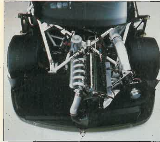
El motor, un cinco cilindros en línea va colgado por delante del eje anterior. Los técnicos de Audi han situado el depósito de gasolina por detrás del eje posterior para equilibrar los pesos. Los radiadores son enormes ya que es necesario evacuar gran cantidad de calor.
