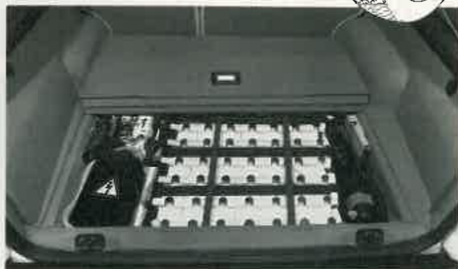
El set de baterías va situado bajo el maletero.
