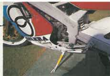
El chasis de la SP 01 es del tipo Deltabox y su freno de 220 milímetros tiene tacto progresivo.
