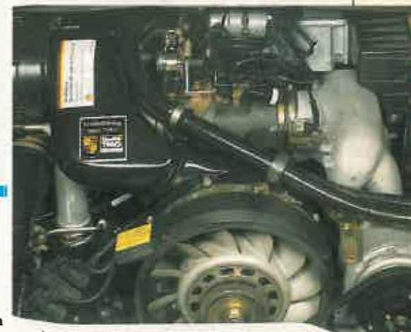
El motor es un seis cilindros boxer que desarrolla 250 caballos.
