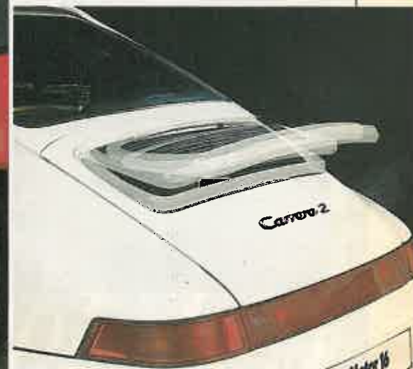
El alerón posterior se sube y se baja automáticamente en función de la velocidad.
