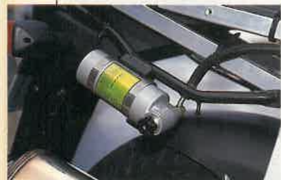
En la suspensión trasera (arriba) se ha separado el depósito del aceite.
