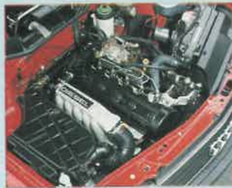
Motor diesel para la serie 100. Ahora la potencia es de 82 caballos
