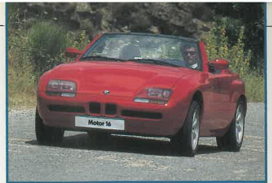
El Z1 hace gala de una estabilidad superior a los modelos de la serie 3. Las torsiones de la carrocería son mínimas gracias a un chasis muy estudiado.
