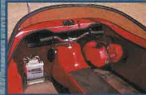
Un manillar, idéntico al de las motos, permite conducir los hovercraft.
