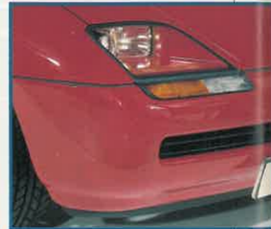
Parachoques y carrocería en termoplástico. Los faros, son de última generación.
