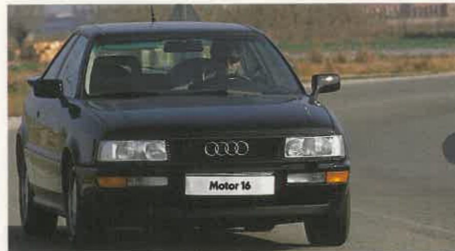
El frontal del coupé es muy parecido al de sus hermanos, los 80 y 90. Pero el coeficiente aerodinámico se ha mejorado, logrando un Cx de 0,32.
