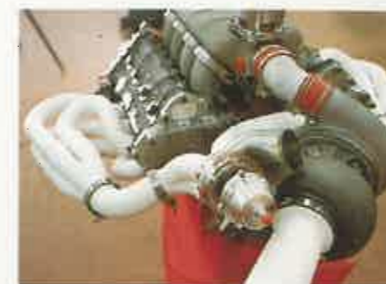
Garrett ha hecho un nuevo turbocompresor para esta mecánica que usará metanol.
