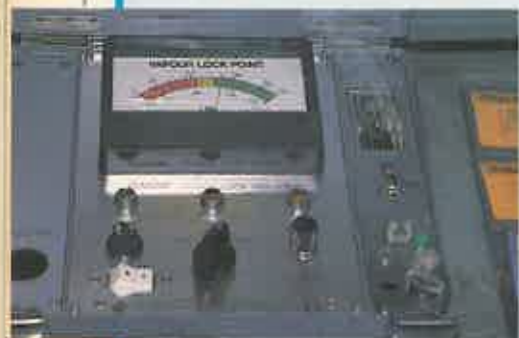
El líquido de frenos, después de 15.000 km, había perdido efectividad.
