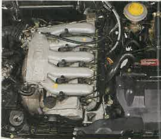
Nuevo motor con cuatro válvulas por cilindro. En España tendremos la versión de 160 caballos
