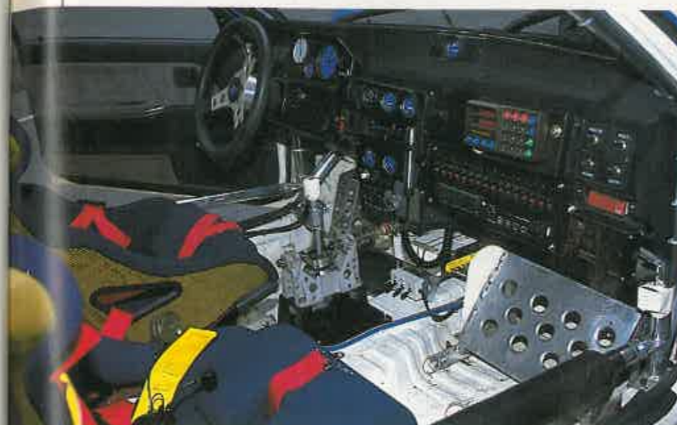
Los pilotos de Mazda tienen a su alcance todas las informaciones posibles, dispuestas de manera bastante conveniente. Llama la atención la timonería del cambio X-Trac de seis velocidades.
