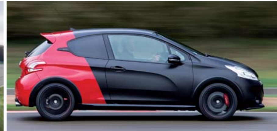
▲ La mano de Peugeot Sport lo hace más imponente. Recibe suspensiones más firmes, muelles 10 milímetros más cortos, pinzas Brembo de cuatro pistones... Pero lo más importante es la adopción de un autoblocante mecánico Torsen que hará que disfrutemos si rodamos en circuito.
