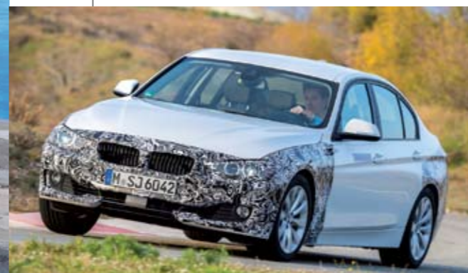
▲ En modo eléctrico, la velocidad punta alcanza 120 km/h. Y se puede circular hasta 35 kilómetros sin emisiones.
