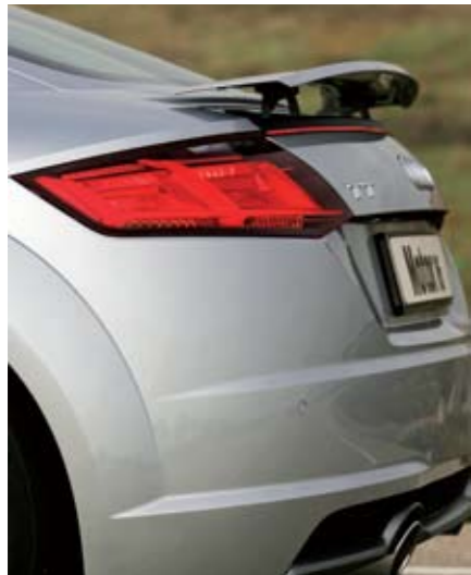
▲► Tiene luz diurna atrás. El alerón emerge a 120 km/h y desciende al bajar de 70. El comportamiento del TT es magnífico, y eso que este TDI no puede llevar tracción quattro.
