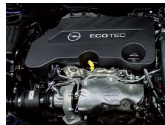
◀ La nueva generación del 2.0 CDTI con 170 CV debuta en Insignia y Zafira Tourer. Tiene Reducción Selectiva de Catalización SCR y ofrece un 5% más de potencia y un 14% más de par que el actual 2.0 CDTI de 163 CV. Cumple Euro 6 y reduce gasto y emisiones.
