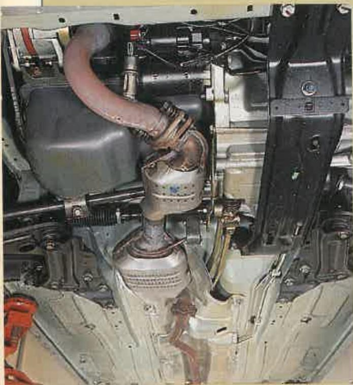
**CON CATALIZADOR.** En primer término la sonda Lambda en el escape. Sobre la marmita del catalizador la protección térmica.
