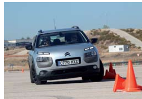
▲ La frenada con esquivas en mojado permite comprobar la eficacia del ABS, sistema que impide el bloqueo de las ruedas y permite esquivar obstáculos. Con el eslalon se comprobó la agilidad y la rapidez de la dirección del C4 Cactus, un modelo se agarra muy bien en las curvas.
