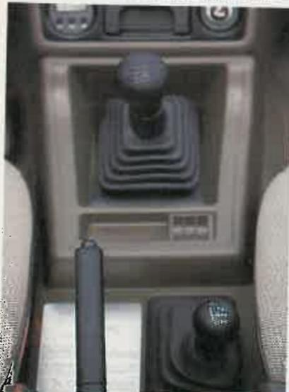
La palanca del cambio y de la transmisión. Hay que parar el coche para usar la reductora.
