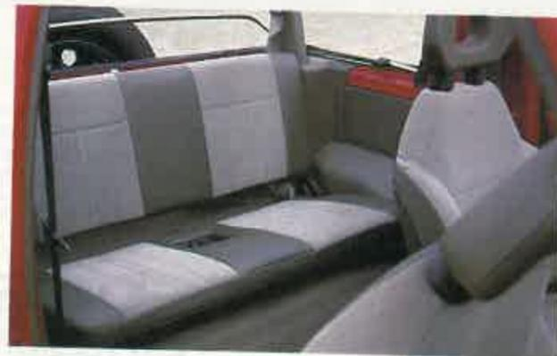
La versión descapotable tiene el asiento posterior de una sola pieza. En la versión de techo duro, se abate en dos sectores simétricos.
