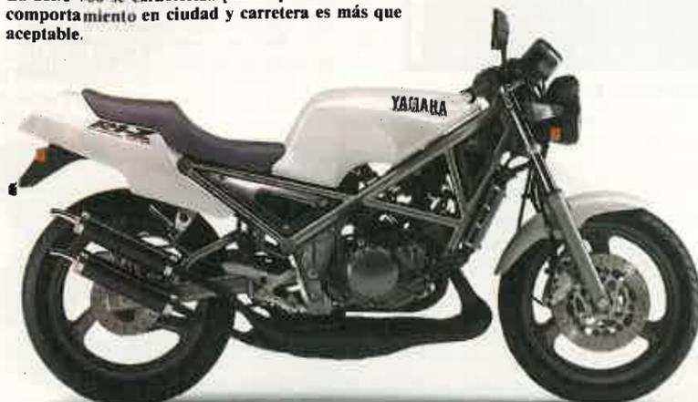
El hábitat natural de la R1-Z es la ciudad. El chasis es multitubular y el motor es un bicilíndrico de 249 centímetros cúbicos.
