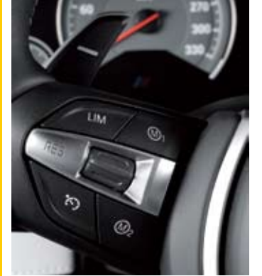
▲ Desde el volante se pueden seleccionar y memorizar los diferentes programas que actúan sobre dirección, suspensión, cambio... El chasis M adaptativo cuesta 2.342 euros.
