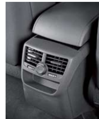
▲ Para mejorar el confort en las plazas traseras, hay estas salidas de ventilación. Puede tener climatizador de cuatro zonas.
