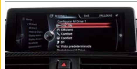
▲ Desde el volante se pueden seleccionar y memorizar los diferentes programas que actúan sobre dirección, suspensión, cambio... El chasis M adaptativo cuesta 2.342 euros.
