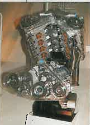
Motores multiválvulas (cinco por cilindro) y de componentes cerámicos.
