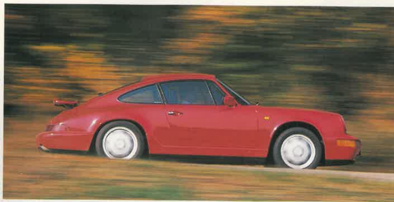
Comportamiento muy mejorado en este Carrera 2, más racional que los antiguos 911 El alerón trasero sólo se levanta por encima de una velocidad. La aerodinámica es importante
